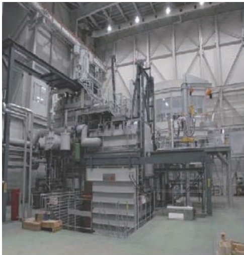
a. 真空感应炉 (3t, 真空度 7 \times 10^{-4} mbar)
