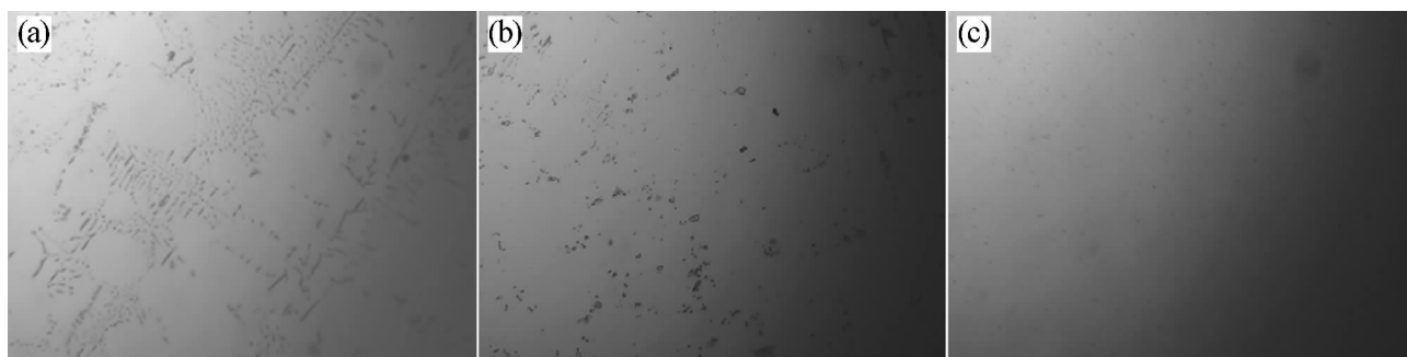
图 2 热等静压处理前后镍基高温合金的缺陷(未腐蚀) \times 200
