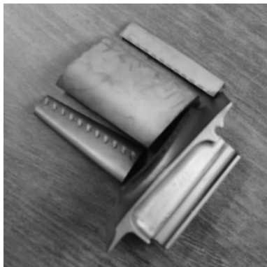
图 1 镍基铸造高温合金样品(热等静压处理前)
